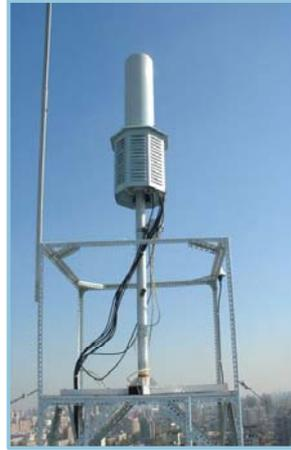
Fig 4.3.3. 8-Element-Antenna-Array
