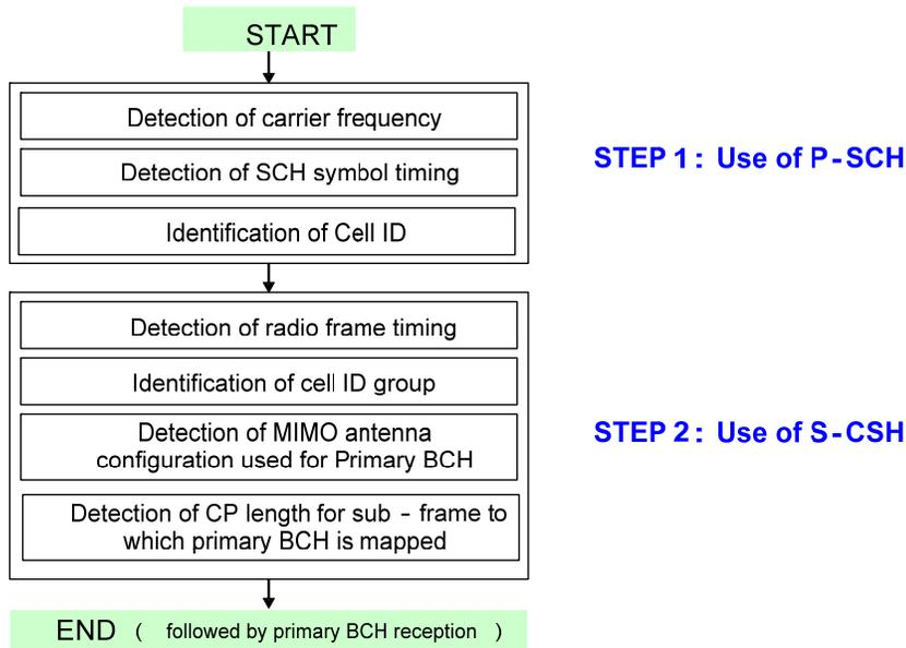
**Figure 21. Cell Search Flow Diagram<sup>158</sup>**
