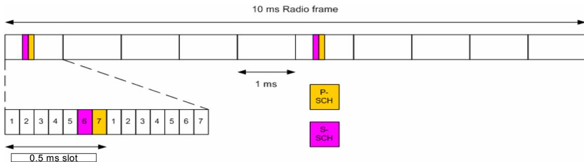
**Figure 20. SCH Frame Structure<sup>157</sup>**
